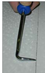
Rys. 32 Test próbnikiem zgrzewu
